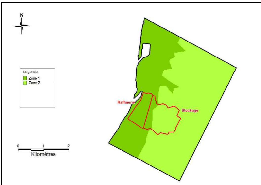
Figure 17 : Zonage des paramètres hydrodynamiques de la couche 4 (craie)
